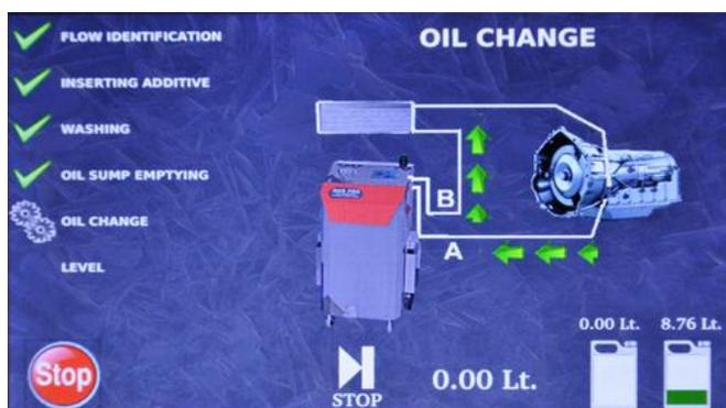
Das Ölwechsel beginnt und in dieser Phase muss man den Motor ein- und ausschalten nach dem Lichtanzeigen. Das Zyklus endet, wenn das Licht startet zu blinken.
