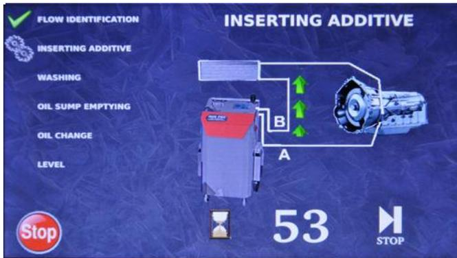
Nach der Stromwiedererkennung wird das Reinigungszusatzmittel hinzugefügt, das in der geeigneten Flaschen ist.
