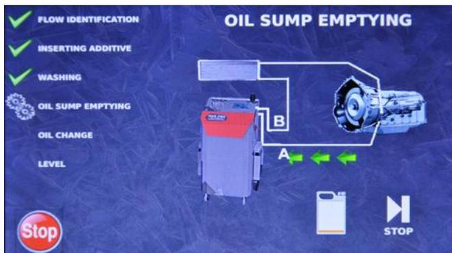
Wenn man die Funktion gewählt hat, wird die Phase der Tankentleerung starten. Schalten Sie den Motor aus, wenn das grüne Licht schaltet sie aus oder man Blasen in der gebrauchten Ölkontrolleuchte sieht.
