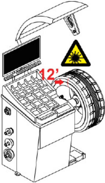
Fig. 47 — Correction intérieure ALU1 à 12 heures et à 6 heures. Fig. 48 — Positions de collage et d'agrafage ALU1–ALU7.
